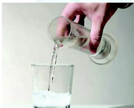
США. Они занимались разработкой вещества, которое могло бы впитывать и сохранять максимальное количество воды. В итоге получили полимер на основе крахмала, в котором часть собственных молекул была замещена молекулами нитрида акриловой кислоты. Полимер способен впитывать воду в объеме, превышающем его собственный в 400 раз!
